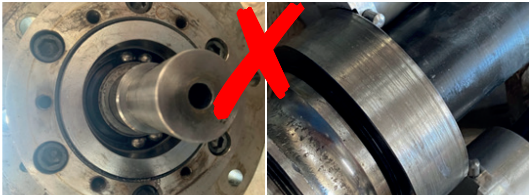
图 15: 轴承 左: 磨损的轴承，缺失保持架，并带多个滚动体 右: 轴承内圈的滚道嵌入沉积物
