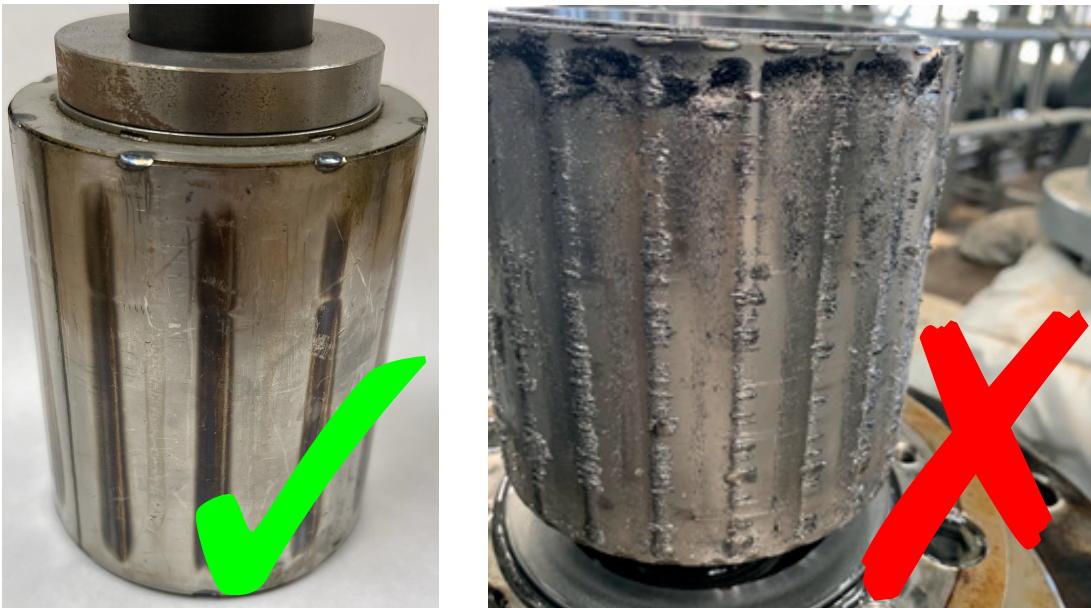
图 14: 内转子 左: 无附着物的内转子 右: 内转子上积聚大量铁颗粒
