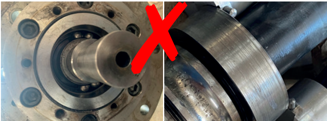
图 14: 轴承 左: 磨损的轴承, 缺失保持架, 并带多个滚动体 右: 轴承内圈的滚道嵌入沉积物
