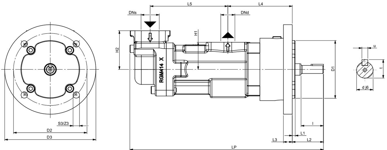
Anschlussmaße bei Stahl- und Gussgehäuse ident.
