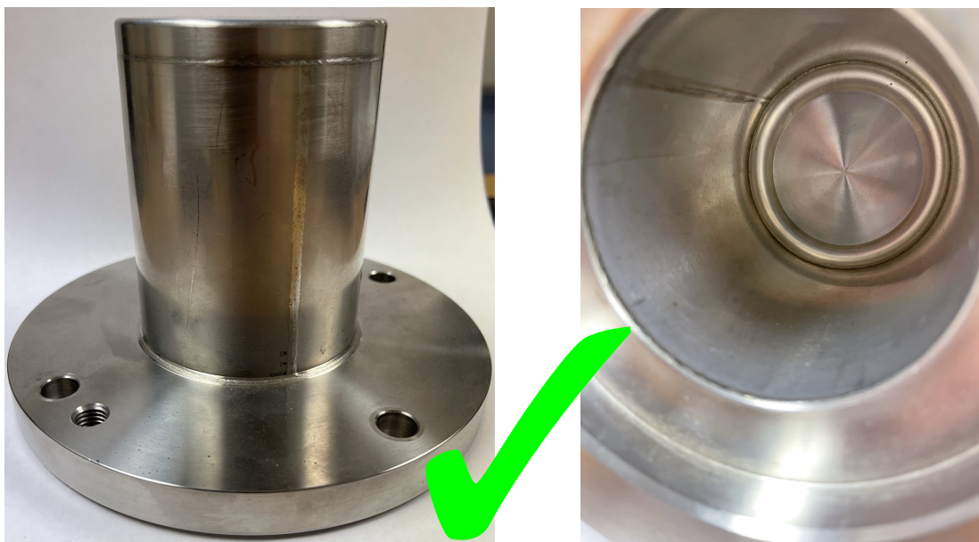
图 9: 安全壳 左: 外表面无槽纹 右: 内侧无槽纹
