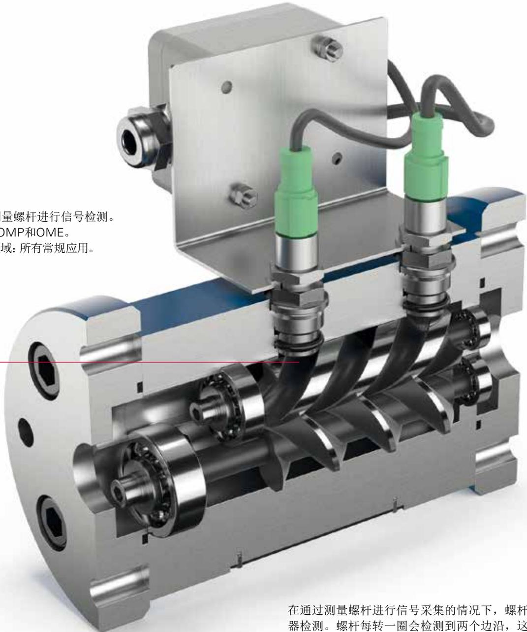
在通过测量螺杆进行信号采集的情况下，螺杆边沿由脉冲变送器检测。螺杆每转一圈会检测到两个边沿，这会导致螺杆每转一圈产生两个脉冲。由于螺杆旋转输送了精确的测量室容积，因此每个测量室容积会产生两个脉冲。对于所有常规消耗和流量测量应用，这种信号检测是一种经济实惠的解决方案。
